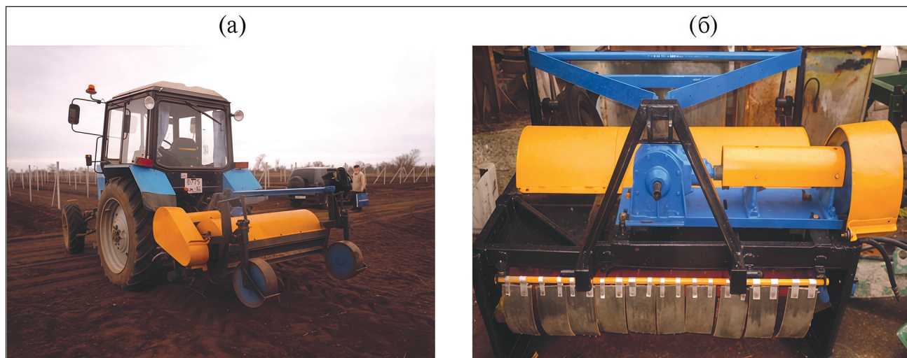
Рис. 1. Общий вид макетного образца подборщика-измельчителя виноградной лозы: (а) сбоку; (б) спереди.
