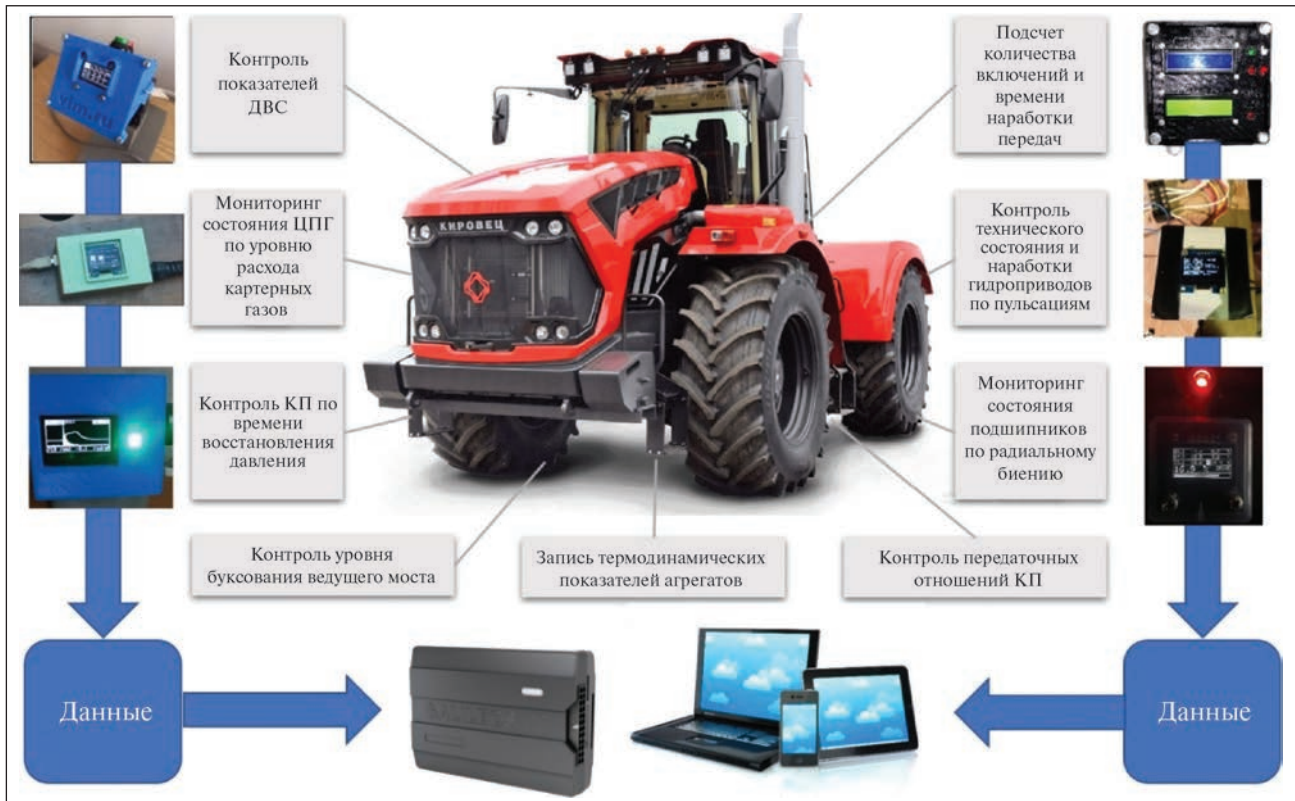
Рис. 1. Интеллектуальный программный комплекс с цифровыми средствами сбора, передачи и анализа диагностических данных технического состояния техники.
