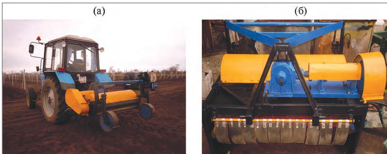
Рис. 1. Общий вид макетного образца подборщика-измельчителя виноградной лозы: (а) сбоку; (б) спереди.
