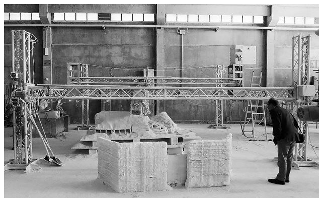
Рис.1. Lunar Habitation, арх. Foster + Partners (2012 г.) и модель технологии её трёхмерной печати
