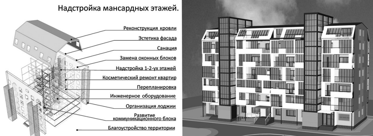
Рис. .6. Реконструкция с надстройкой мансардных этажей
