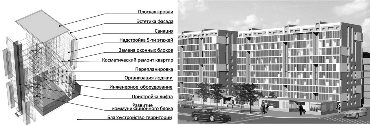
Рис. 9. Реконструкция с надстройкой пяти этажей
