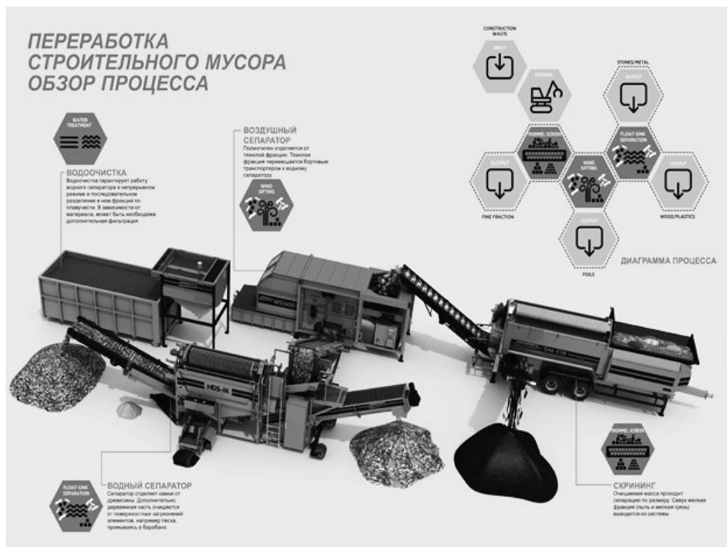
Рис. 1. Основные технологические этапы процесса переработка строительных отходов
