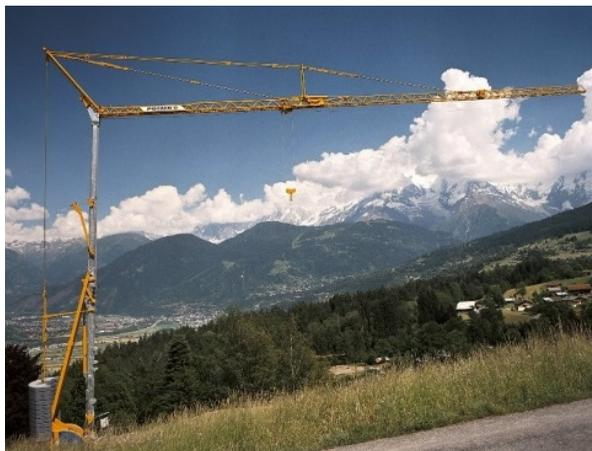
Рис. 5. Быстромонтируемый башенный кран
