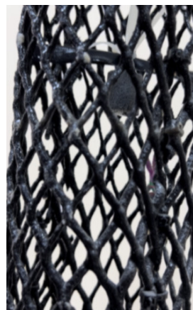
Рис. 3. Биомасса, образованная при применении биоценоза микроорганизмов в составе биопрепарата «Русский Богатырь № 5» при температуре до 25 °С
