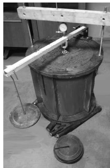
Рис. 2. Общий вид испытательного лотка
