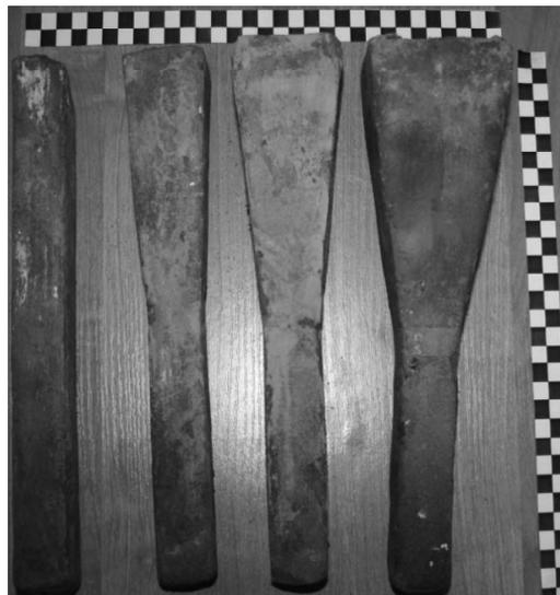
Рис. 4. Общий вид испытываемых моделей свай
