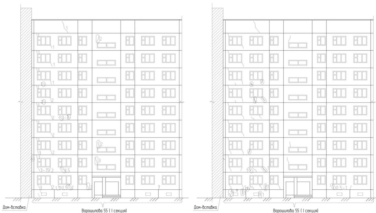
Рис. 5. Карта повреждений на фасаде панельного жилого дома (по данным 2010–2011 гг.)
