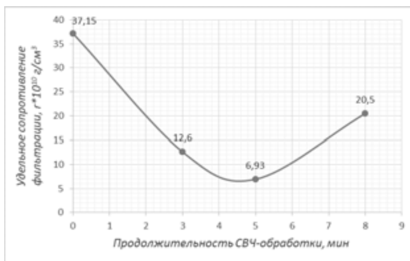
Рис. 4. Зависимость удельного сопротивления фильтрации смеси осадков от продолжительности их СВЧ-обработки
