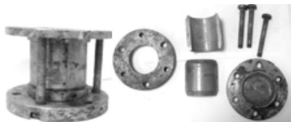
Рис. 1. Форма для изготовления образцов из гиперпрессованного бетона
