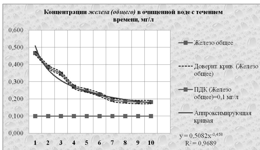
Рис. 5. График работы установки для очистки сточных вод по железу (общему)
