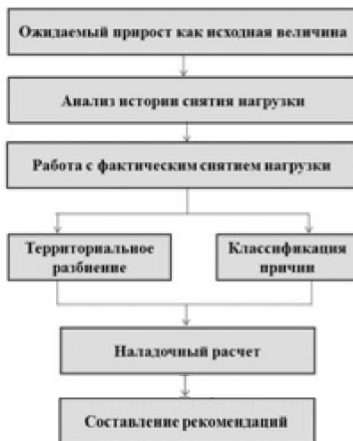
Рис. 1. Структурная схема методики планирования нагрузок системы централизованного теплоснабжения
