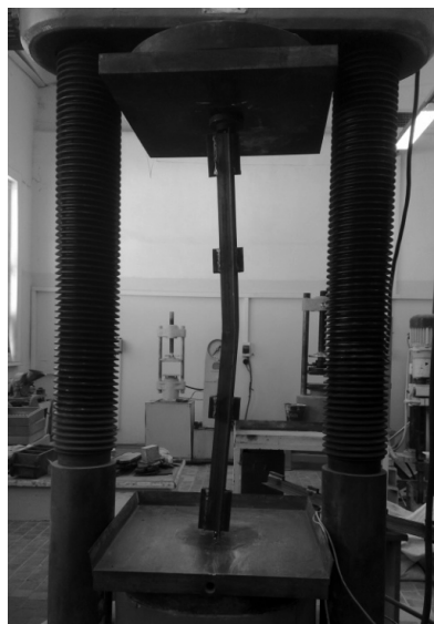
Рис. 6. Испытание стержня 2-й серии
