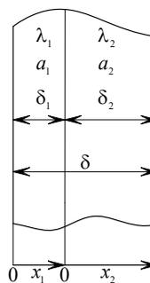
Рис. 1. Схема применения локальных систем координат для двухслойной пластины
