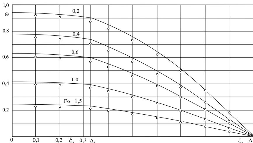
Рис. 2. Распределение температуры в двухслойной пластине: ○ – по формулам (10), (11) в третьем приближении; — — метод конечных разностей
