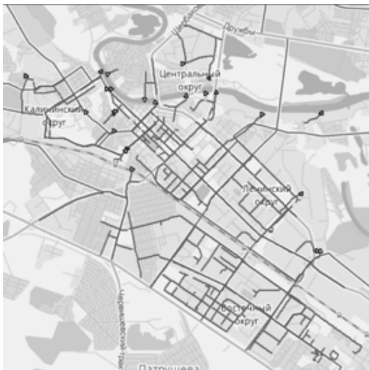
Рис. 1. Схема расположения коллекторов и выпусков дождевой канализации [13]
