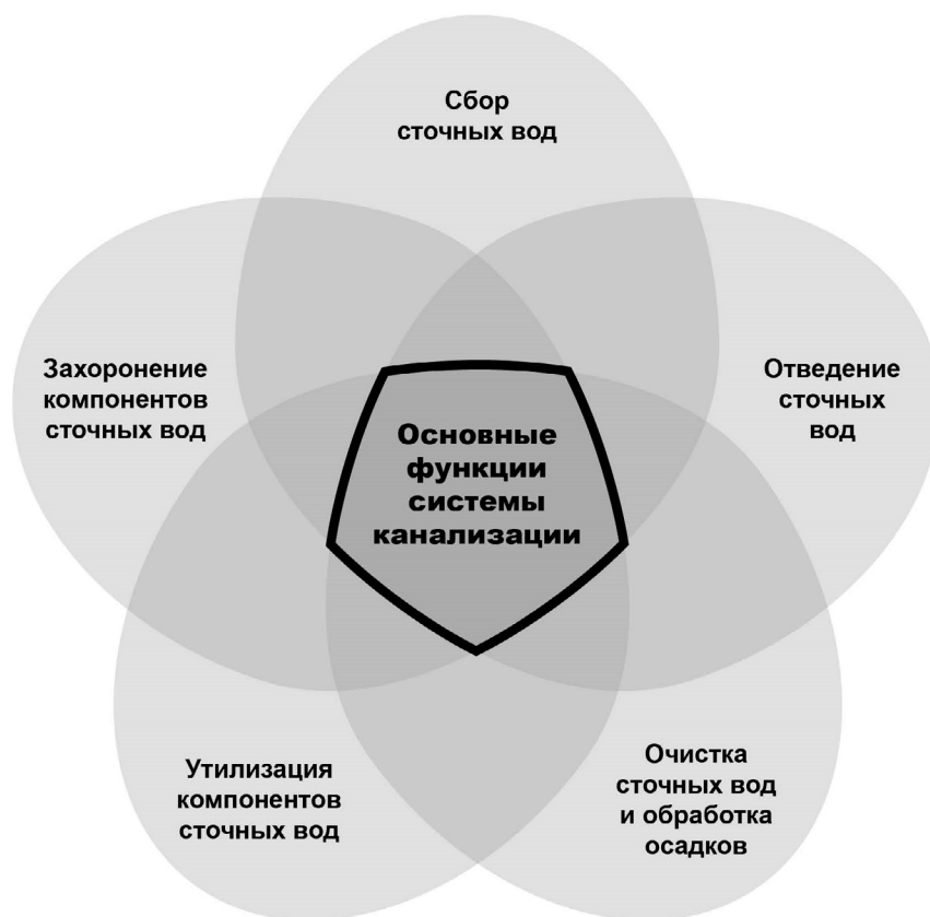
Рис. 2. Основные функции системы канализации поселения
