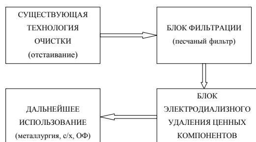
Рис. 3. Блок-схема очистки низкоконцентрированных сточных вод, образующихся при разработке медноколчеданных месторождений
