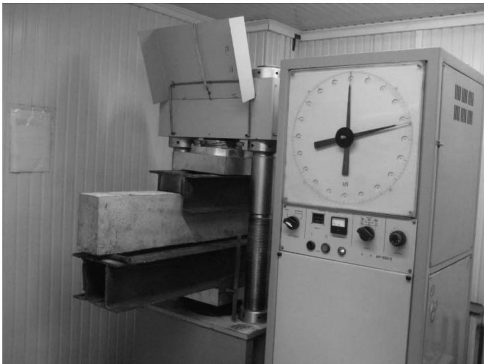
Рис. 5. Испытание железобетонных перемычек марки ЗПБ 16-37 разрушающей нагрузкой
