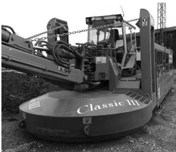
Рис. 1. Общий вид земснаряда-амфибии Watermaster
