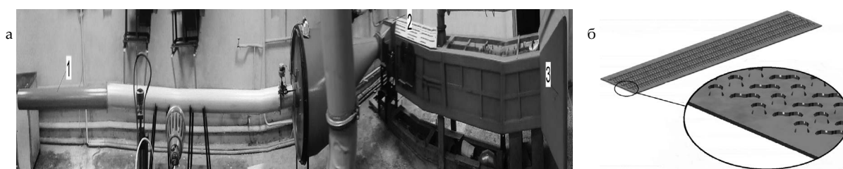
Рис. 4. Экспериментальный стенд (а) и развертка поверхности с интенсификаторами (лунками в форме гантели (б): 1 – напорный патрубков; 2 – вентилятор; 3 – всасывающий патрубков
