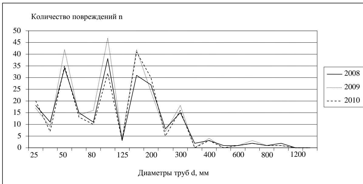
Рис. 2. Повреждения на стальных трубопроводах
