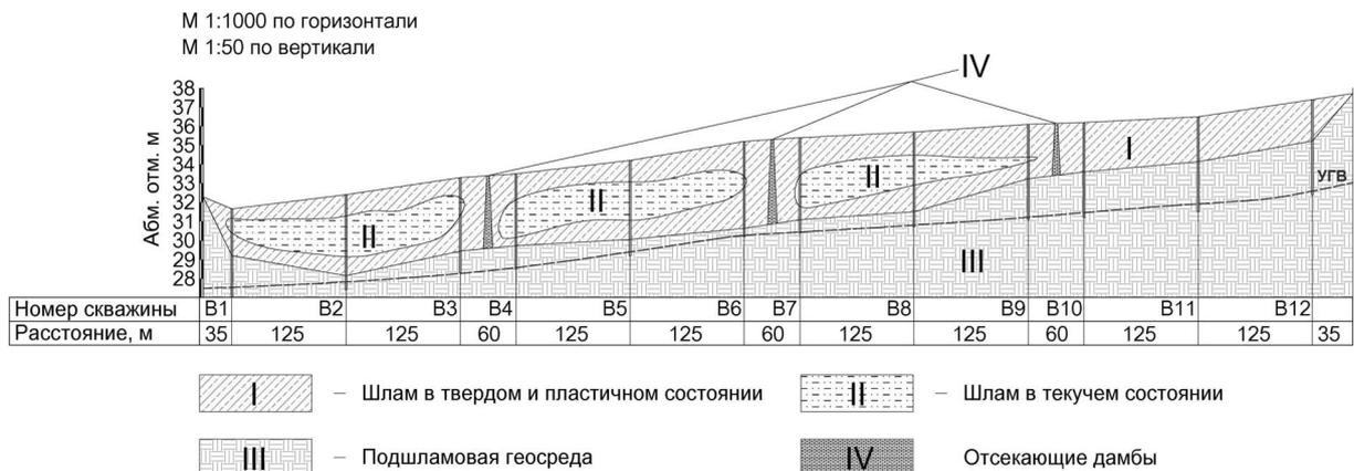
Рис. 2. Продольный разрез накопителя
