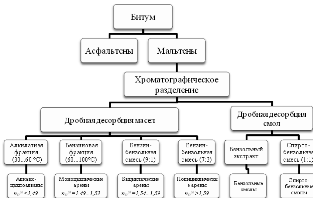
Рис. 1. Разделение смолисто-асфальтовых веществ по методу ВНИИ НП
