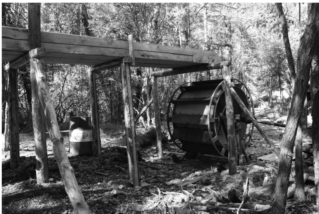
Рис. 1. Фото водоналивного колеса и подводящего лотка: а – вид сбоку; б – вид сзади
