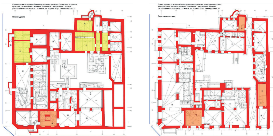
Рис. 6. План подвала и первого этажа с обозначением предмета охраны: фасадов, несущих конструкций стен, лестниц и сводов Монье Fig. 6. The plan of the basement and the first floor with the designation of the subject of protection: facades, load-bearing structures of walls, stairs and arches of Monier
