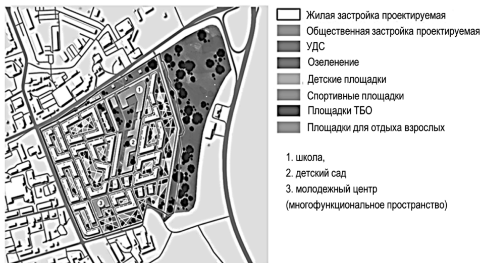
Рис. 4. Схема архитектурно-планировочного решения территории жилого квартала в Ханты-Мансийске Fig. 4. The scheme of architectural and planning solutions for the residential area in Khanty-Mansiysk
