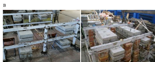
Рис. 2. Экспериментальная рама: а – конструктивная схема на 1-м этапе; б – конструктивная схема на 2-м этапе; в – фото Fig. 2. Experimental frame: a – constructive scheme at the 1st stage; b – constructive scheme at the 2nd stage; c – photo
