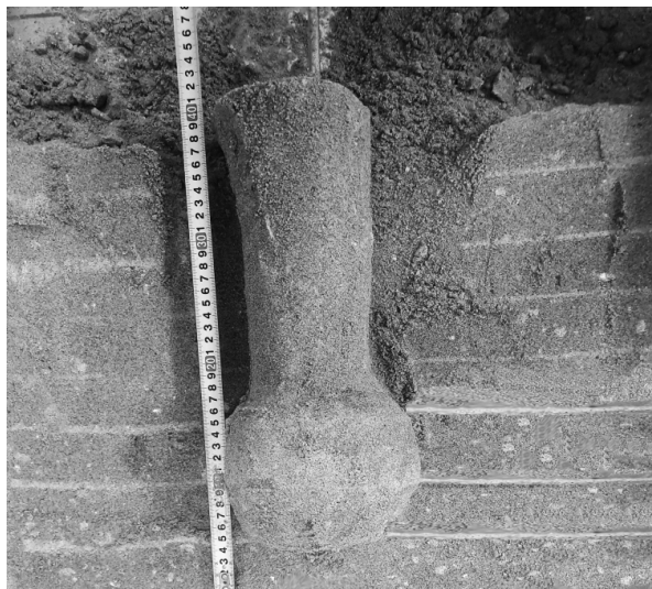
Рис. 5. Модель сваи с грунтополимерным уширением, выполненная с индикаторными прослойками Fig. 5. Model of a pile with soil-polymer widening, made with indicator layers
