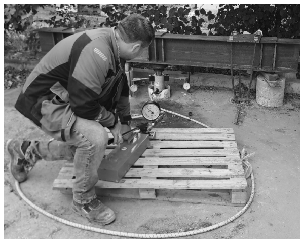
Рис. 10. Испытание вертикальной статической вдавливающей нагрузкой сваи БСГПУ30-25 Fig. 10. Testing of vertical static pressing load of pile SBGPU30-25
