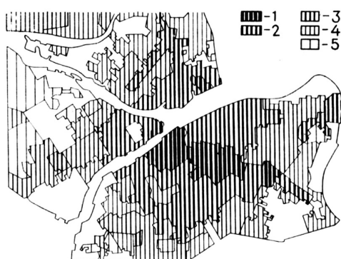
Рис. 3. Схема зонирования территории центральных районов по степени сложности градостроительной ситуации (наибольшая сложность в зоне Невского проспекта): 1–5 – уровни центральности (по мере удаленности от центра) Fig. 3. Zoning scheme of the territory of the central regions according to the degree of complexity of the urban planning situation (the greatest complexity in the Nevsky Prospekt zone): 1–5 – centrality levels (as far away from center)
