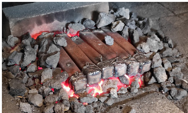
Рис. 5. Стальные многослойные пакеты, помещенные в кузнечный горн Fig. 5. Steel multilayer packages placed in a forging crucible
