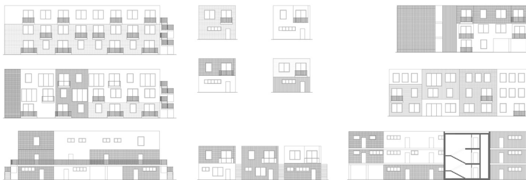
Рис. 8. Варианты фасадных решений домов на основе типовых блок-модулей Fig. 8. Options for facade solutions of houses based on typical block modules
