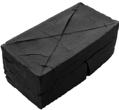
Рис. 4. Кирпич из глины Смышляевского месторождения, обожженный на Тольяттинском кирпичном заводе в туннельной печи при температуре 1000 °С Fig. 4. Clay brick from the Smyshlyaevsky deposit, fired at the Tolyatti brick factory in a tunnel furnace at a temperature of 1000 °С
