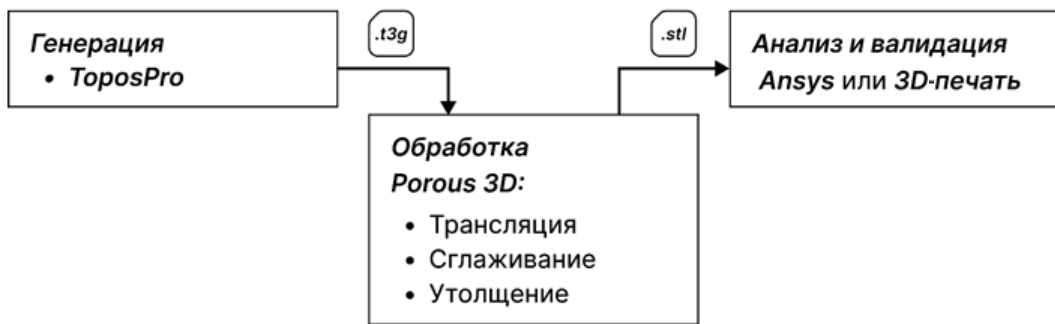
Рис. 2. Разработанный метод для моделирования пористых материалов, впервые реализованный в работе [11]
