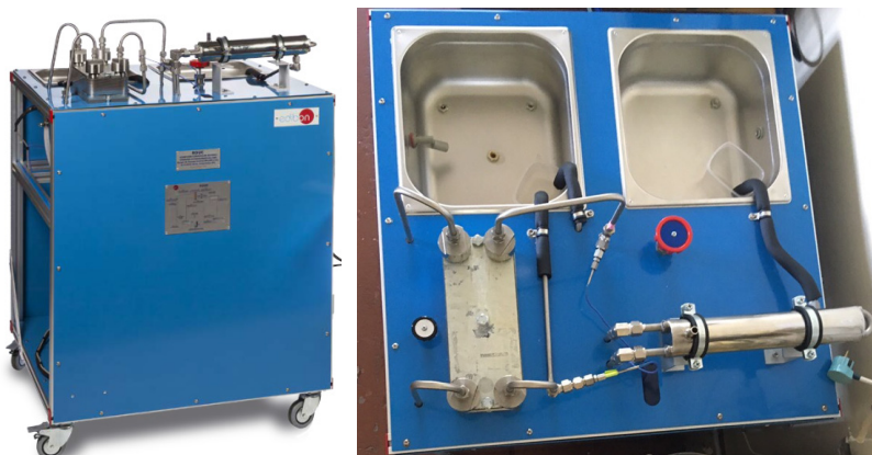
Рис. 1. Общий вид установки обратного осмоса ROUC Fig. 1. General view of the ROUC reverse osmosis plant
