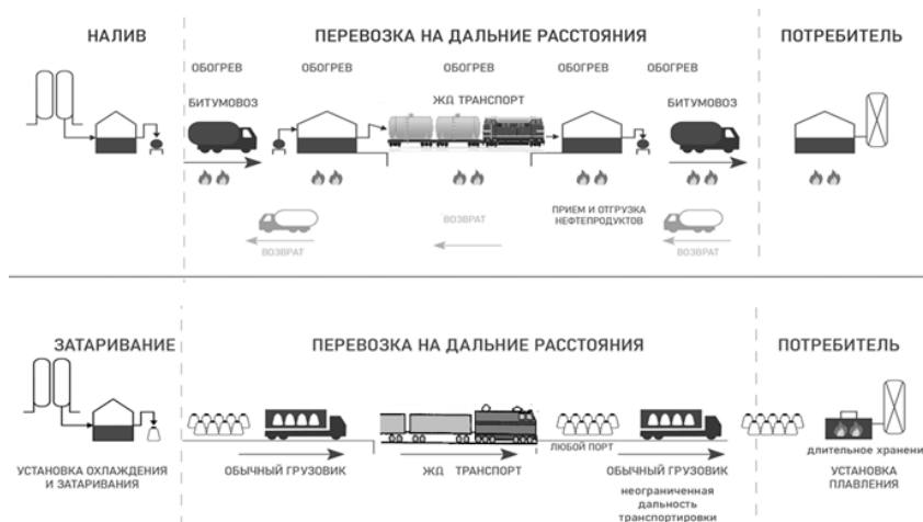
Рис. 1. Принципиальные схемы транспортировки жидких и фасованных битумных вяжущих Fig. 1 Schematic diagrams of transportation of liquid and packaged bitumen binders
