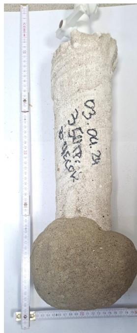
Рис. 3. Модель сваи с грунтополимерным уширением, при устройстве которого использовано 350 г смолы
