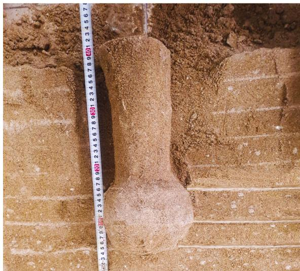
Рис. 5. Модель сваи с грунтополимерным уширением, выполненная с индикаторными прослойками
