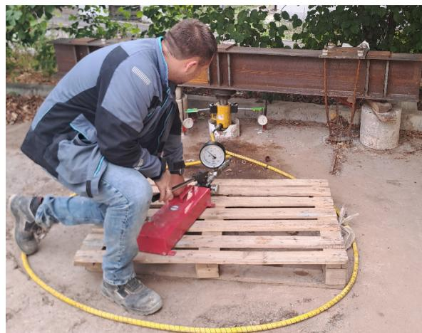
Рис. 10. Испытание вертикальной статической вдавливающей нагрузкой сваи СБГПУ30-25
