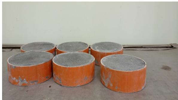
Рис. 1. Торкрет-бетонные образцы. Внешний вид перед испытанием
