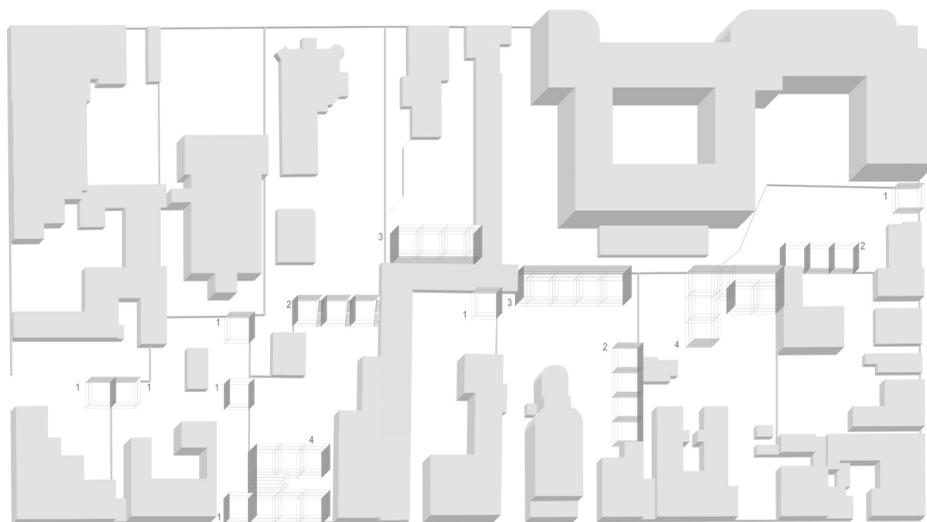
Рис. 7. Реконструкция архитектурно-планировочной структуры дворов с использованием домов на основе типовых блок-модулей: 1 – точечный дом; 2 – заблокированный дом; 3 – галерейный дом; 4 – дом с лестнично-лифтовым блоком
