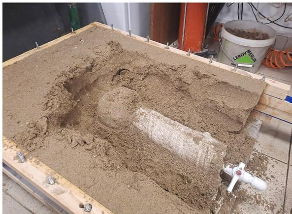
Рис. 2. Модель сваи с грунтополимерным уширением под нижним концом
