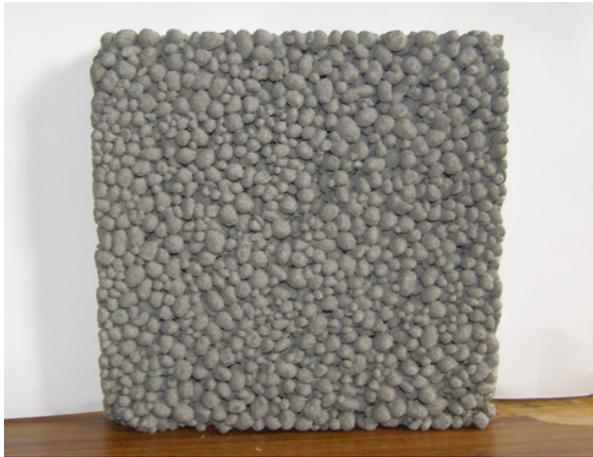
Рис. 1. Образец из керамзитобетона
