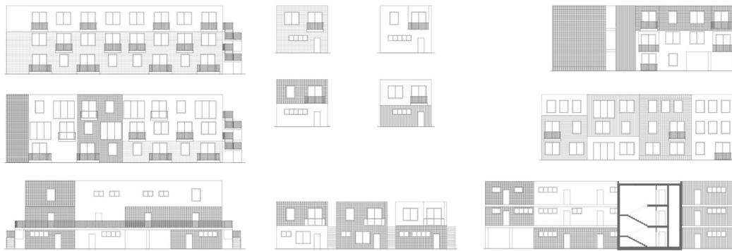
Рис. 8. Варианты фасадных решений домов на основе типовых блок-модулей
