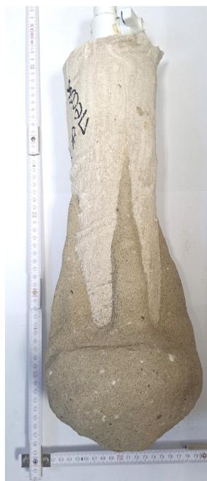
Рис. 4. Модель сваи с грунтополимерным уширением, при устройстве которого использовано 550 г смолы
