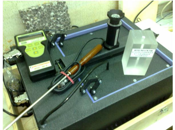
Рис. 2. Измеритель теплопроводности ИТП-МГ 4 «250»
