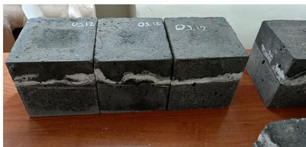
Рис. 2. Внешний вид образцов торкрет-бетона после выдержки в растворе щелочи
