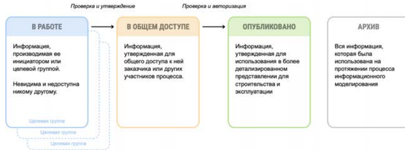
Рис. 2. Структура среды общих данных Fig. 2. Structure of the Common Data Environment
