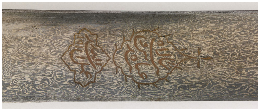
Рис. 1. Узор дамасской стали на лезвии сабли Fig. 1. Damascus steel pattern on a saber blade
