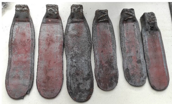
Рис. 6. Стальные многослойные пакеты послековки Fig. 6. Steel multilayer packages after forging
