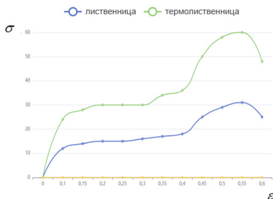
Рис. 3. Сравнительная диаграмма образцов на сжатие Fig. 3. Comparative diagram of compression samples
