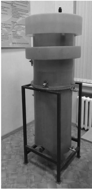
Рис. 1. Установка для очистки сточных вод
