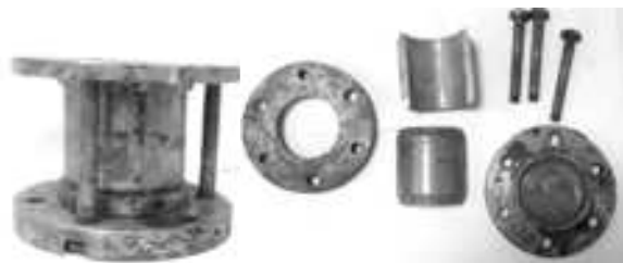
Рис. 1. Форма для изготовления образцов из гиперпрессованного бетона
