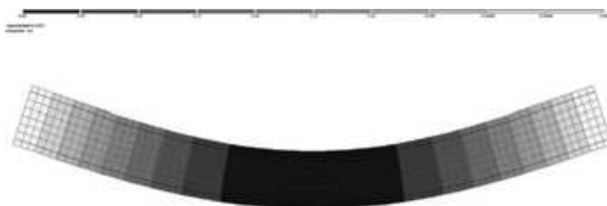
Рис. 3. Прогиб балки при линейной постановке численного эксперимента в ПК «Лира САПР-2017R3»
