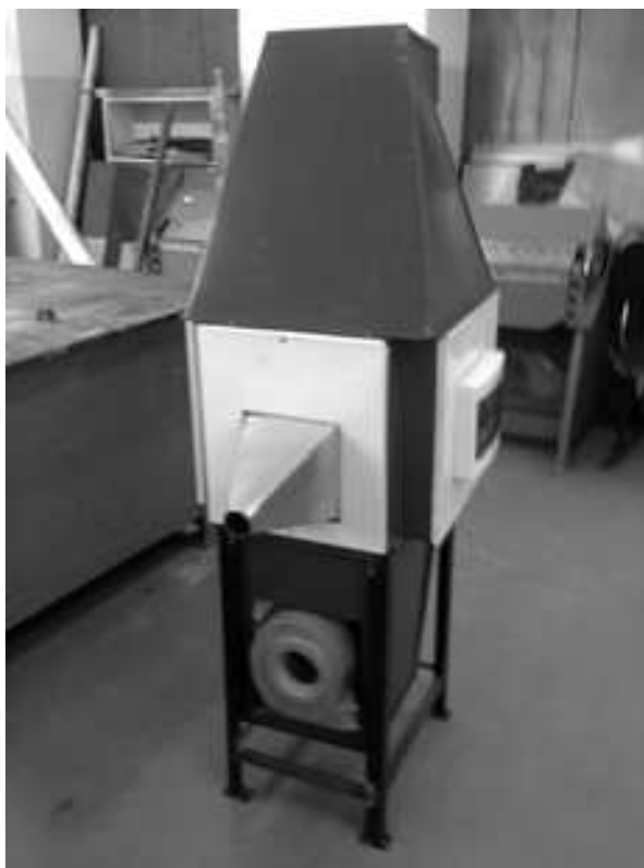
Рис.2. Схема и общий вид двухконтурного теплогенератора для РСЛО
