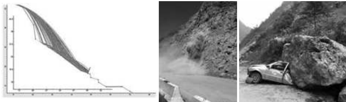
Рис. 1. Траектория падения каменных обломков
