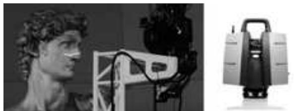
Рис. 5. Сканирование скульптуры. 3D сканер Lieca ScanStation P30
