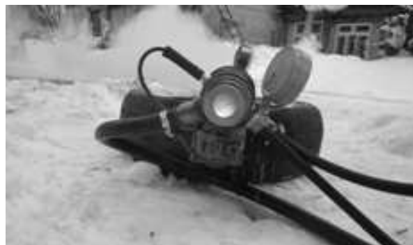
Рис. 3. Полевые испытания теплогенератора ТГ-2А
