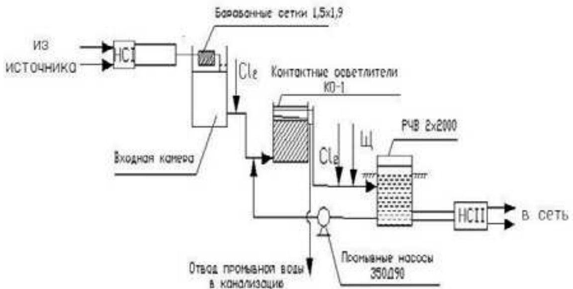
Рис. 5. Существующая схема очистки воды на ВОС г. Сегежи
