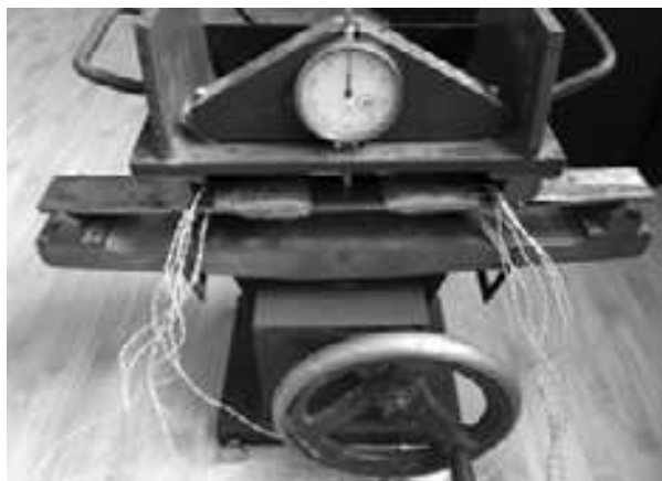
Рис. 2. Установка для проведения тарировочных испытаний
