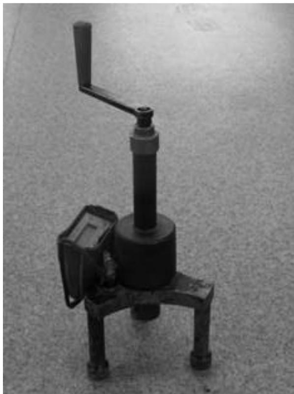
Рис. 2. Измеритель прочности бетона ПОС-30 МГ 4 «Скол»
