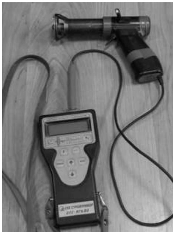
Рис. 3. Электронный измеритель прочности ИПС МГ 4.03
