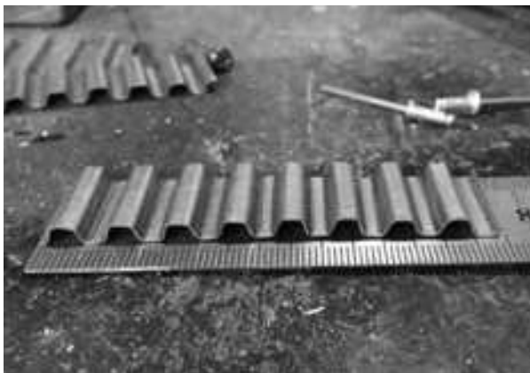
Рис. 3. Фрагмент гофрированной пластины (теплопередающей стенки)
