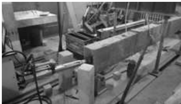
Рис. 3. Натяжение каната на бетон опытного образца
