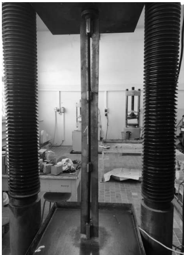
Рис. 6. Испытание эталонного стержня
