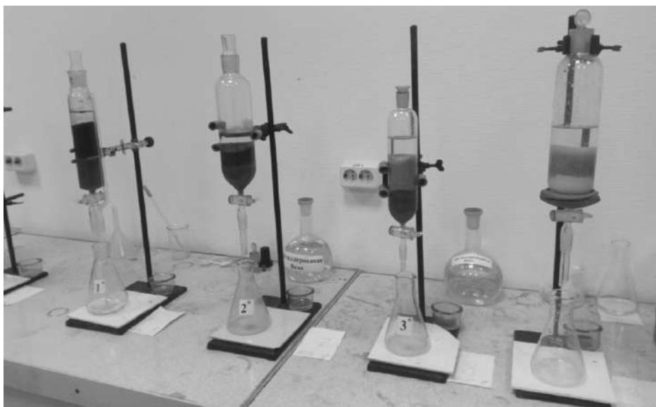
Рис. 1. Комплексные установки с послойной загрузкой в одной делительной воронке. Первое приближение. (Слева направо: уголь акт. + Н-кат, керамзит + Н-кат, кварц, песок + Н-кат, Н-кат+ анионит)
