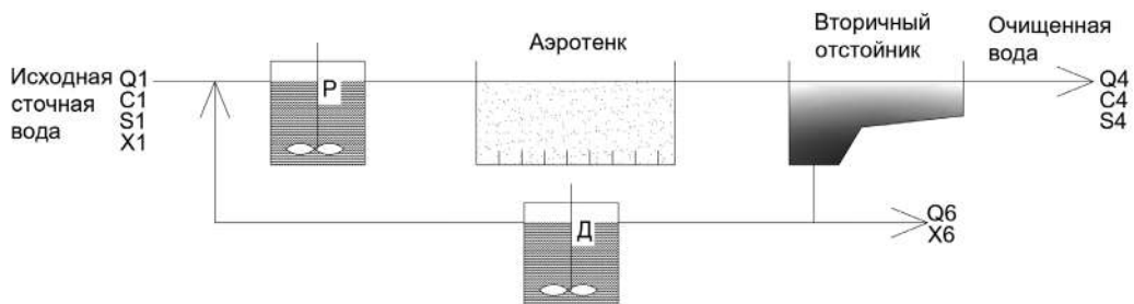
Рис. 2. Схема процесса биологического удаления фосфора с использованием аноксидной стабилизации ила [3]
