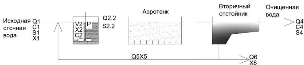
Рис. 1. Схема процесса биологического удаления фосфора (P) [3]: V2 – анаэробный реактор удаления фосфора; V3 – анаэробный/аноксидный реактор; С – общая концентрация (взвешенное + растворенное вещество); S – концентрация растворенного вещества (концентрация субстрата); Q – объемная скорость потока; X – концентрация взвешенных веществ
