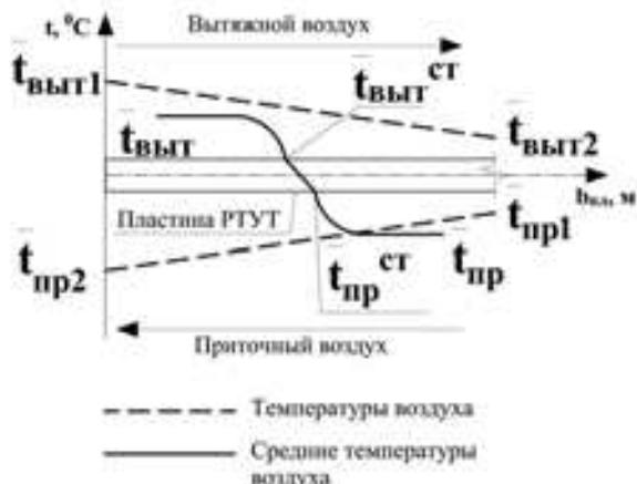
Рис. 2. Общая схема процесса теплообмена
