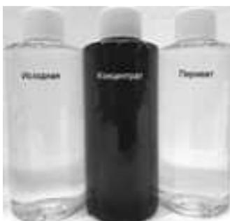
Рис. 13. Фотография проб образцов пермеата, концентрата и исходной воды
