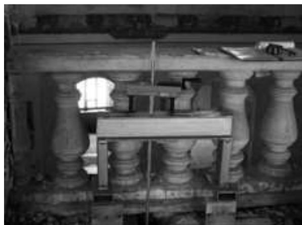
Рис. 9. Вид испытания прочности нормального сцепления в кладке здания Дворянского собрания
