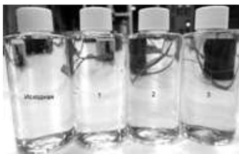
Рис. 10. Фотография отобранных проб пермеата и исходного образца
