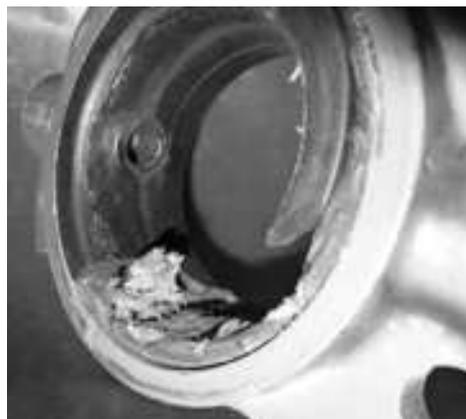
Рис. 1. Разрушение уплотнителя затвора
