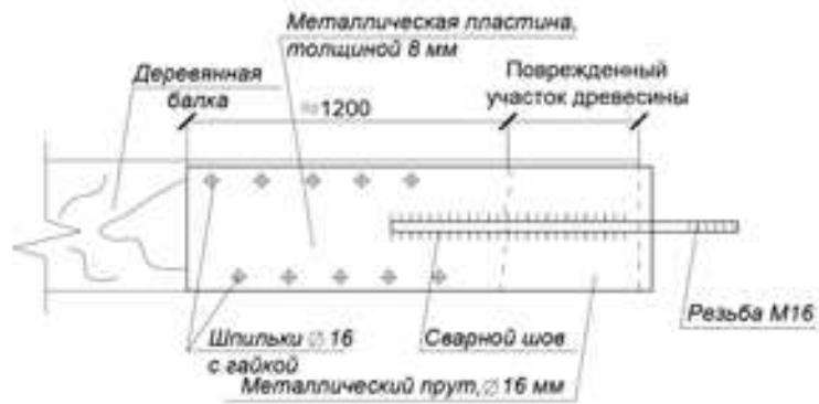
Рис. 2. Деревянная балка с металлическими накладками
