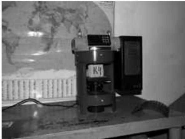
Рис. 6. Разрушающее определение прочности образцов, отобранных в здании Дворянского собрания, изготовленных из фрагментов камней и раствора, отобранных из кладок стен
